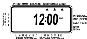
FIGURA 3: Display a cristalli liquidi con le relative informazioni
